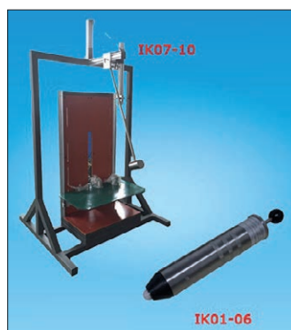
Rys. 5. Młoty probiercze używane w laboratoriach do wykonania badań IK
