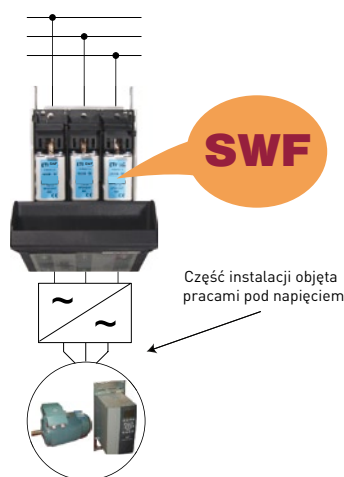
Rys. 1. Wkładki topikowe ochronne SWF zainstalowane w rozłączniku bezpiecznikowym.
