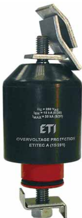
Rys. 2. Wersja ogranicznika Etitec A 15 kA – O z odłącznikiem i zaciskiem na linię niez izolowaną
