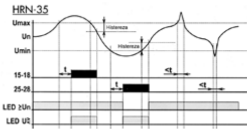
Rys. 5. Diagram działania przekaźnika HRN-35
