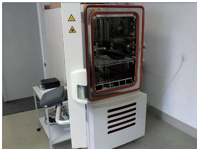
Rys. 7. Urządzenie do wykonywania próby zgodnie z IEC 60068-2-30
