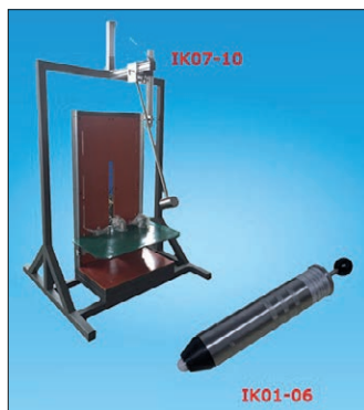
Rys. 5. Młoty probiercze używane w laboratoriach do wykonania badań IK
