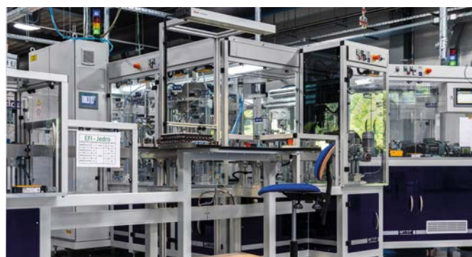
Rys. 2. Początek zautomatyzowanej linii produkcyjnej EFI-P: przekładniki Ferrantiego dostarczane są do stanowiska A, gdzie są instalowane w obudowach wyłączników i wlotowywane do elektronicznej płytki drukowanej; przewody fazowe przechodzące przez środek przekładnika wlotowywane są do zacisków górnych oraz do miedzianych wsporników styków ruchomych
