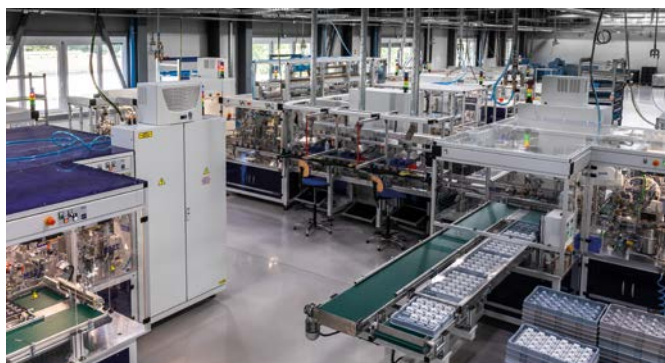
Rys. 4. Końcowy etap produkcji wyłącznika różnicowoprądowego EFI-P, gdzie montowana jest obudowa przednia wyłącznika wraz z przyciskiem „Test” oraz zapinka umożliwiająca solidny i szybki montaż wyłącznika na szynach montażowych DIN
