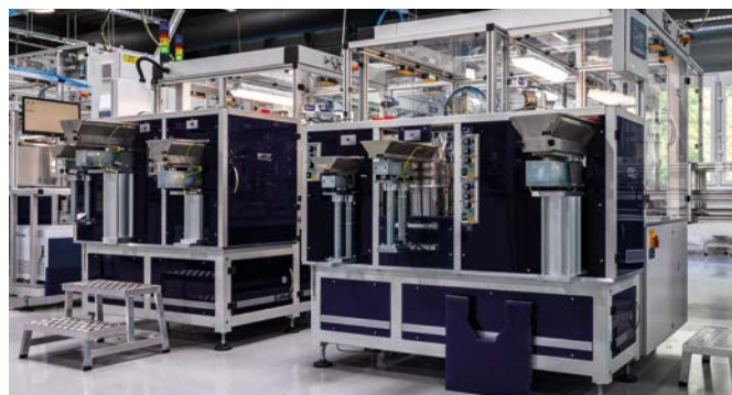
Rys. 3. Cała linia produkcyjna wyłączników różnicowoprądowych EFI-P składa się ze stanowisk, w których następuje montaż każdego z elementów wyłącznika. Powyższe zdjęcie prezentuje stanowisko C i D, gdzie następuje montaż styku ruchomego oraz instalowane są elementy zacisków wyłącznika
