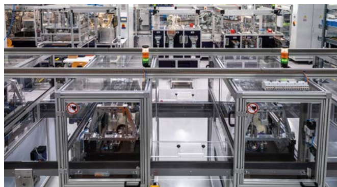
Rys. 5. Zdjęcie przedstawia automatyczną linię testującą, która jest ostatnim etapem procesu produkcyjnego. Na tym stanowisku wykonywana jest kompletna procedura testowa (próba wysokonapięciowa, pomiar prądu różnicowego, czasu zadziałania itp.)
