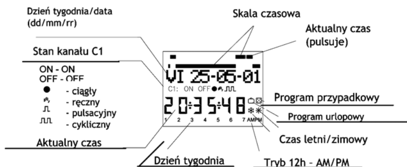
Rys. 9. Układ ikon na wyświetlaczu programatora Eticlock 10
