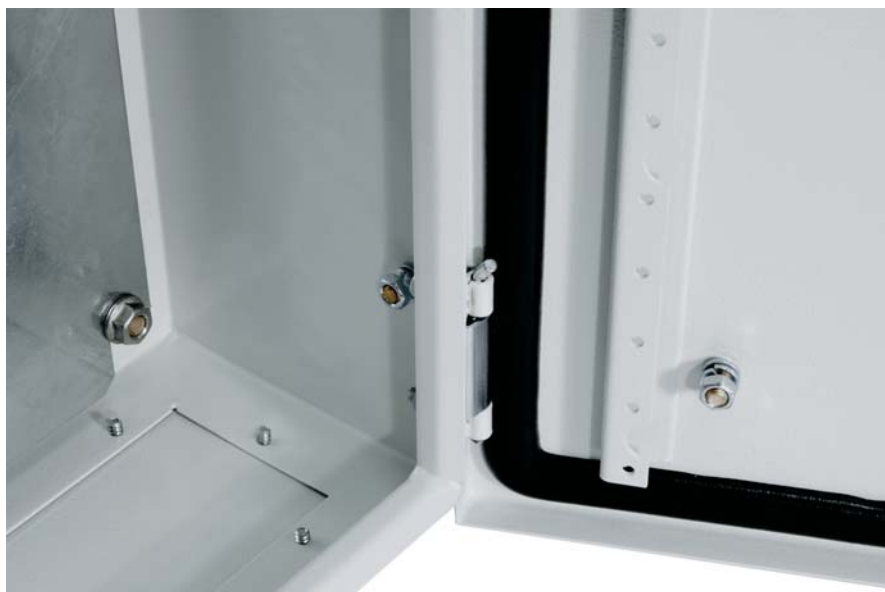
Rys. 10. W korpusie i drzwiach obudowy znajdują się zaciski uziemiające M6x12
