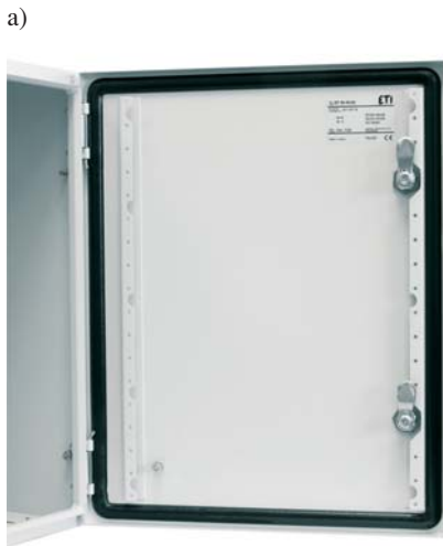
Rys. 7. Drzwi w obudowach od wysokości 400 mm posiadają profile pionowe z otworami montażowymi o rozstawie 25mm (a). Drzwi w obudowach od szerokości 800 mm posiadają profile poziome wyposażone w otwory montażowe o rozstawie 25 mm (b)
