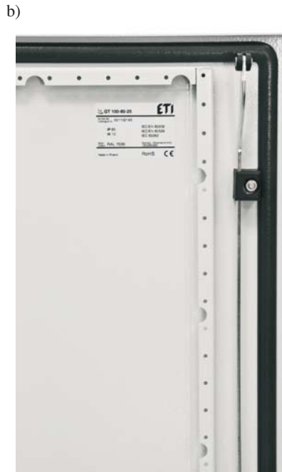
Rys. 7. Drzwi w obudowach od wysokości 400 mm posiadają profile pionowe z otworami montażowymi o rozstawie 25mm (a). Drzwi w obudowach od szerokości 800 mm posiadają profile poziome wyposażone w otwory montażowe o rozstawie 25 mm (b)
