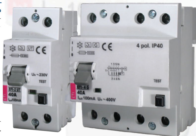
Wyłącznik różnicowoprądowy EFI-2 UT (z lewej) z podwyższoną odpornością na udar prądowy -3kA (8/20) i wyłącznik różnicowoprądowy EFI-4 G/KV krótkozwłoczny (z prawej).
