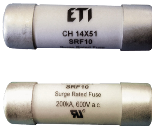
Rys. 2. Bezpieczniki topikowe cylindryczne SRF do zabezpieczania ograniczników przepięć klasy B
