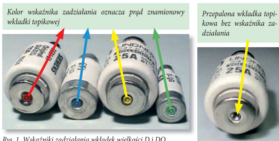
Rys. 1. Wskaźniki zadziałania wkładek wielkości D i DO
