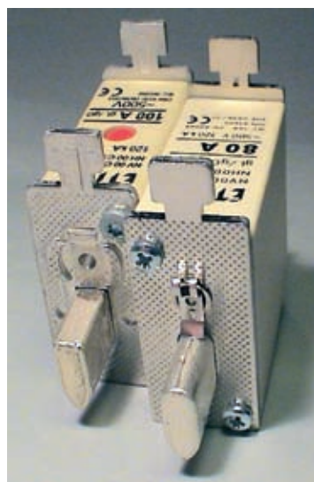
W specjalnym zagłębieniu umieszczony jest czerwony krążek, który w momencie przepalenia się elementu topikowego odpada z zagłębienia
