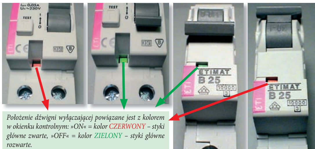
Rys. 3. Dźwignia przełączająca z oznaczeniem I-O, oznaczenie ON – OFF na dźwigni i okienko kontrolne na wyłącznikach: nadprądowym ETIMAT i ochronnym EFI.
