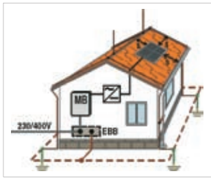
Rys. 9. Obiekt z zewnętrzną instalacją odgromową
