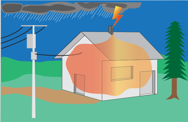
Bezpośrednie wyładowanie w element dachu budynku
