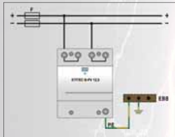
Układ połączeń T ogranicznika B-PV
