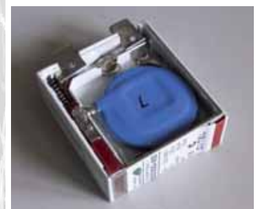
Rys. 2 Schemat ogranicznika przepięć z warystorem i z zabezpieczeniem termicznym
