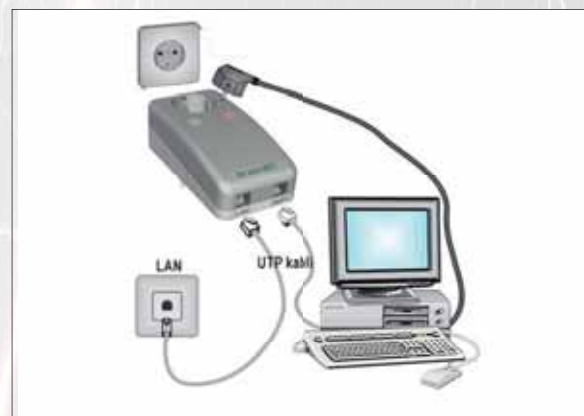
Rys. 3 Ochrona komputera - sieć zasilająca i linia przesyłu danych (LAN- za pomocą uniwersalnego ogranicznika ZE 200 NET
